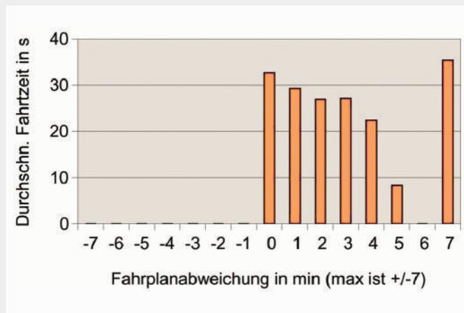
Die Grafik zeigt an einem Beispiel aus der Praxis, dass die Fahrplanlage durchaus die Fahrzeit beeinflussen kann. Im gezeigten Fall ist der Trend der kürzeren Fahrzeit bei steigender positiver Fahrplanabweichung (Verspätung) klar erkennbar.
